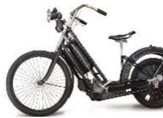
En 1894 Hildebrand et Wolfmüller presentent à Múnich la première motocyclette qui fut fabriqué en serie avec un clair objectif commercial. La Hildebrand et Wolfmüller se mantent en production jusqu'en 1897.
