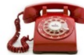
le S63 est à cadran, ses matériaux principaux: Corps, combiné et cadran en plastique, fil électrique en cuivre recouvert de plastique. Il sert à communiquer 1963
