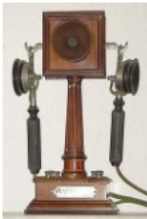
le téléphone d'ader est sans numérotation, ses principaux matériaux : Corps en bois, écouteurs en acier, fils électriques en cuivre recouvert d'une tresse en coton. Il sert à communiquer 1880
