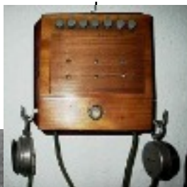
le téléphone mildé est à touches, ses principaux matériaux: Corps en bois, écouteurs en acier avec poignées en bois, fils électriques en cuivre recouvert d'une tresse en coton. Il sert à communiquer 1892
