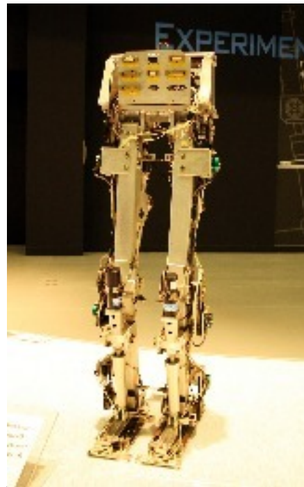
Le premier ASIMO a été créé dans un premier temps par les ingénieurs qui ont cherché à maîtriser la marche humaine. Ainsi, les premiers robots n'étaient qu'une simple paire de jambes articulées. Créé en 1986
